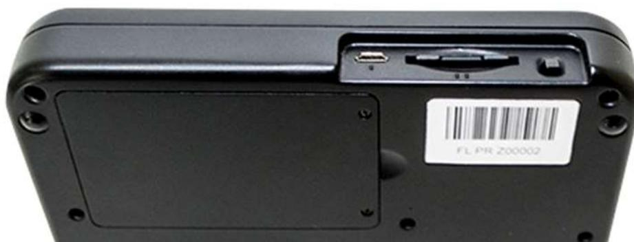
Il vano batteria si trova sul fondo del dispositivo.
