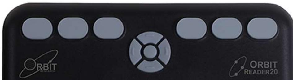
In modalità Stand-Alone, i tasti di input Braille sono utilizzati per la navigazione e la modifica/scrittura.
